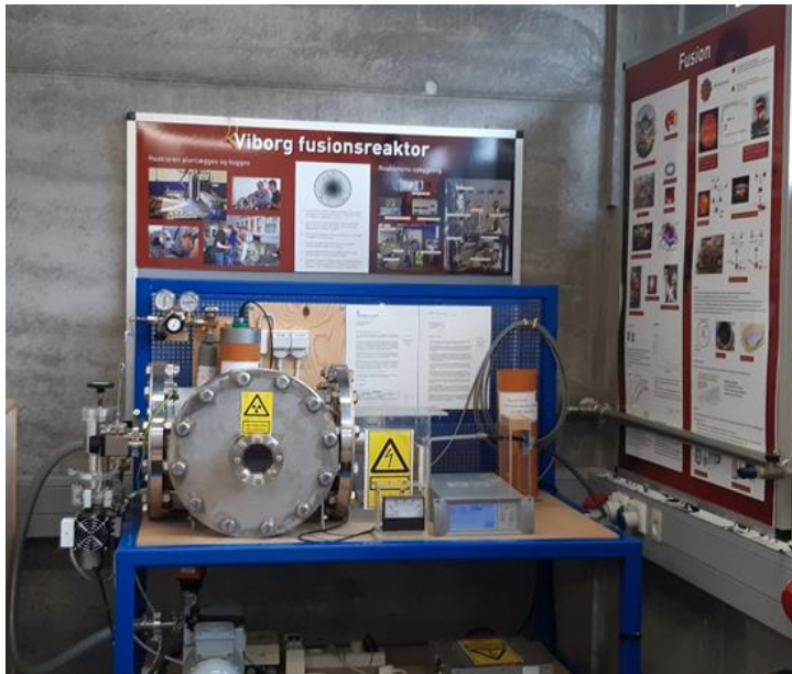
Zelf ontwikkelde en gebouwde fusie reactor
